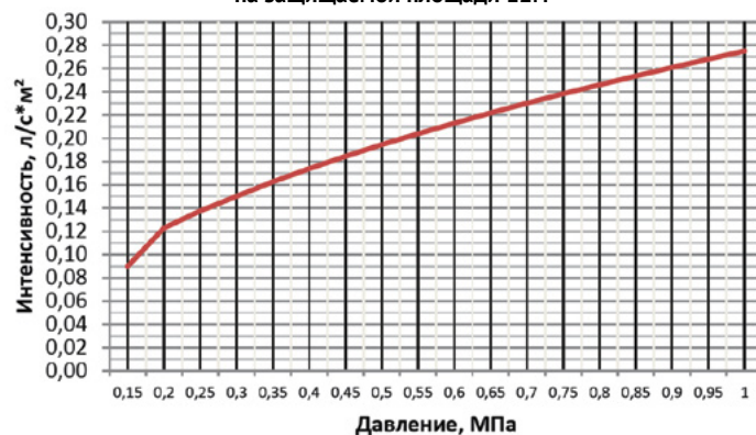
График зависимости интенсивности орошения от давления при применении пенных растворов с коэффициентом производительности K = 0,6 на защищаемой площади 12\text{ м}^2
